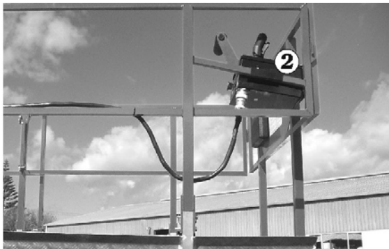
Fig. 6.1.2 - Placering av plattformens manöverbox
