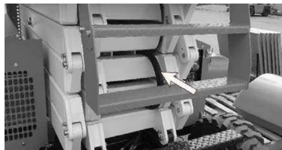
Fig. 7.11 - Kablage i saxpaketet
