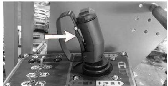
Fig. 2.8 - Dödmansgrepp på joysticken
