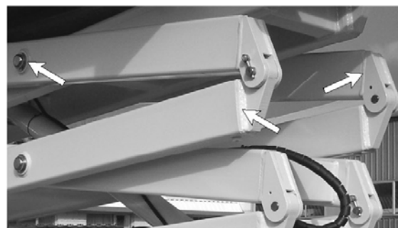
Fig. 7.19 - Skador på konstruktion och svetsar
