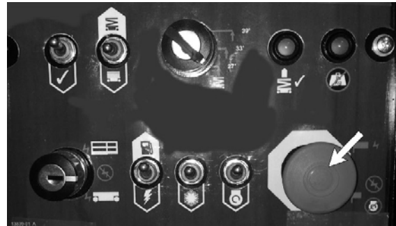
Fig. 8.1 - Nödstoppsbrytare på nedre manöverboxen
