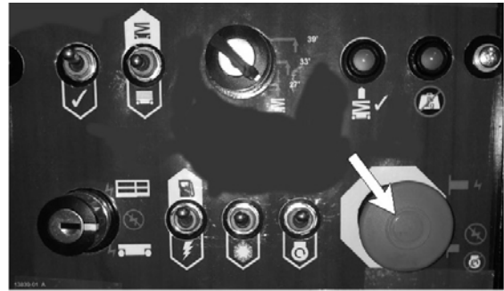
Fig. 2.2 - Nödstoppsbrytare nedre manöverboxen
